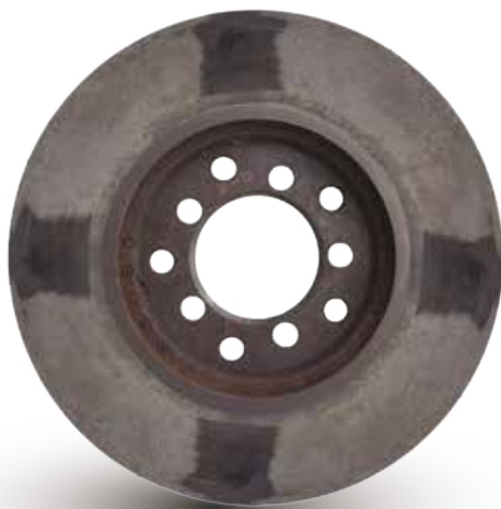
Asiento del disco y de la maza con excesiva oscilación
