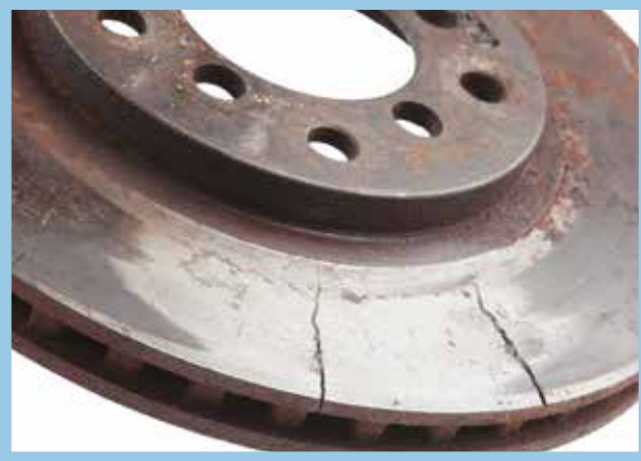
Discos fisurados o con grietas
