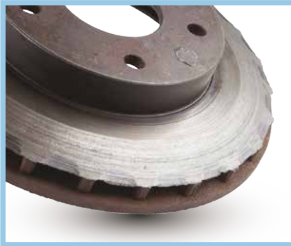
Desgaste por montaje incorrecto de la pinza del caliper
