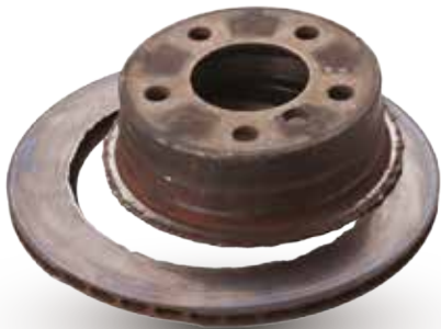
Fractura por apriete incorrecto
