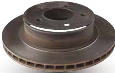
Desprendimiento por apriete incorrecto
