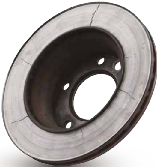
Discos fisurados o con grietas
